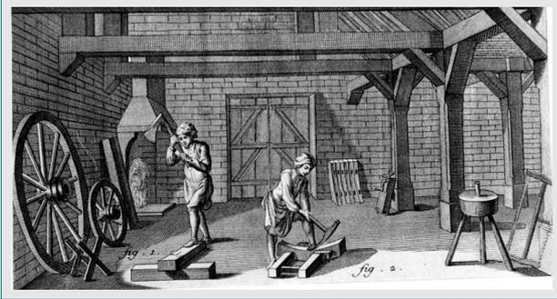
razze venivano fissate a incastro nel mozzo e nella corona. Quindi, su un curvatore a montante, si piegava a mano il nastro di ferro di circa cm 2 di spessore da adattare a cerchione.
